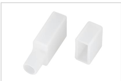
Комплект силиконовых заглушек разработан специально для гибкого неона HALO с сечением 6x13 мм. Включает в себя заглушку с выводом под кабель питания, глухую заглушку. Используйте его с герметиком для максимальной защиты ленты. Габариты заглушек составляют 23x5x14 мм и глухая заглушка 10x5.5x14 мм.
