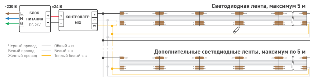
Схема 1. Подключение нескольких светодиодных лент с двух сторон Рекомендуется использовать для обеспечения равномерного свечения ленты по всей длине.
